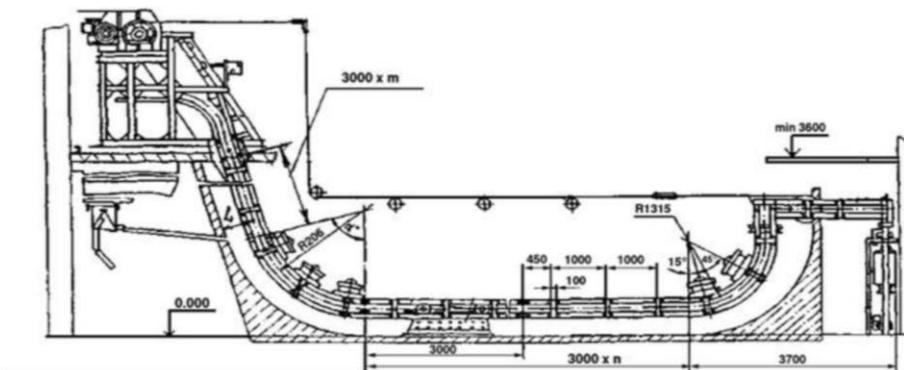
Подъёмник скреперный ковшевый предназначен для удаления (транспортировки), очаговых остатков из-под стационарных паровых и водогрейных котлов в сборный бункер. Удаление (транспортирование) очаговых остатков в сборный бункер осуществляется ковшем, движущимся по направляющим в шлакосборном канале заполненном водой.
